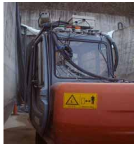
カメラ及び制御盤
